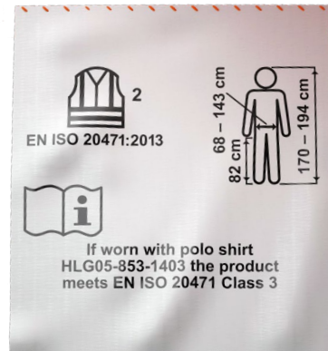
Abb. 3 Ausschnitt eines Etikettes einer Hose Warnkleidungsklasse 2, die ggf. mit einem T-Shirt getragen werden kann und dann Warnkleidungsklasse 3 ergibt.
