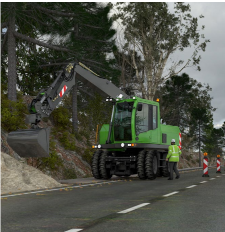
Abb. 5 Erkennbarkeit einer Person mit Warnkleidung vor Arbeitsgerät
